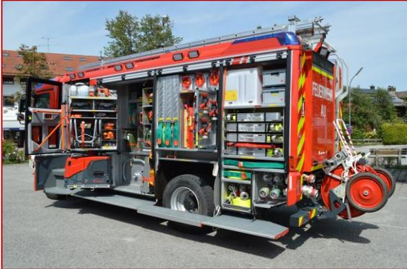
Am Fahrzeugdach sind verschiedene Leitern untergebracht. Für Einsätze mit technischer Hilfeleistung, wie Verkehrsunfälle ist ebenso umfangreiche Ausrüstung auf dem Fahrzeug verladen. Dazu gehören hydraulische Rettungsgeräte, pneumatische Hebekissen sowie diverse elektrische Maschinen und Handwerkzeuge. Das HLF 20 ist somit das Fahrzeug, mit dem jeder Einsatz im Erstangriff bearbeitet werden kann.
